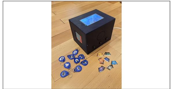
**Transformiertes Rätsel, bei dem durch richtiges Anwenden von Licht- und Soundsensoren ein Code erscheint.**
