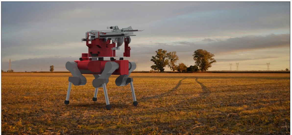
Rendering ANYmal Bodenprobenahme Plattform Eigene Darstellung
