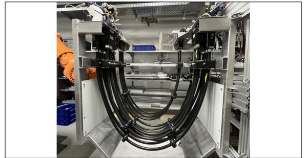
**Modularer Klemmblock zur Fixierung von Kabeln**
