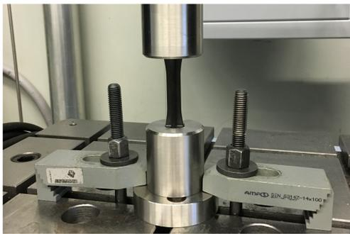
Prüfkörper im Druckversuch
