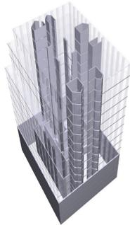
Variantenstudium: Horizontaler Lastabtrag mit sechs Stahlbetonkernen und vier zentralen Stahlbetonwänden im Innenhof
