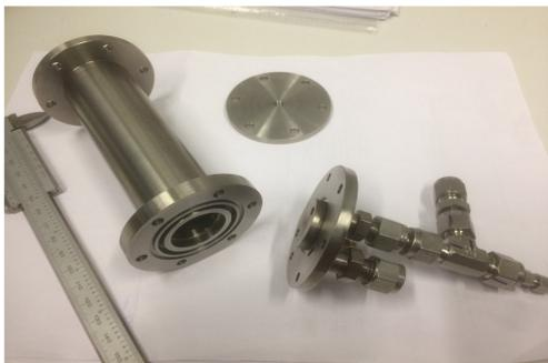
Einzelteile des entwickelten Reaktors
