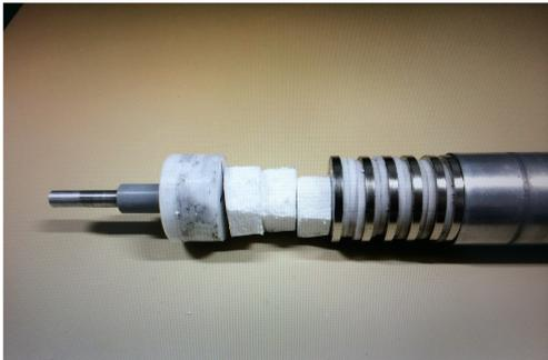
Magnetrolle zur Ablenkung der magnetischen Partikel
