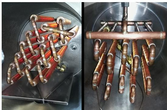
Eingebaute Wärmetauscher mit Kondensatfänger und Kondensatverteiler
