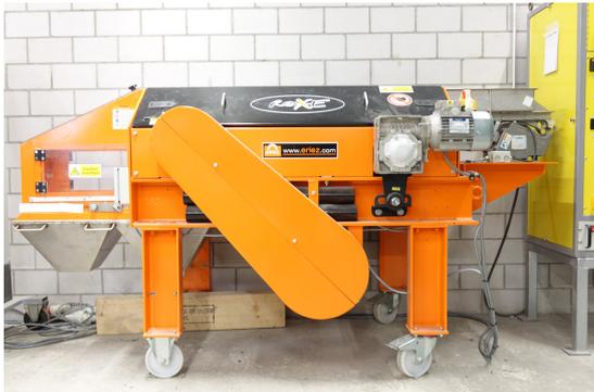
Wirbelstromscheider Eriez Modell Rev-X-E; Umtec Labor, Jona
