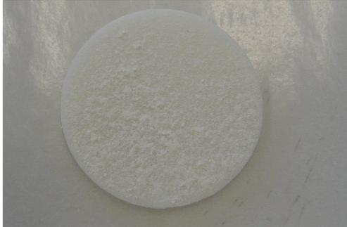
Empfängerphase des Passivsammlers, beschichtet mit einem Material, das Nitrit und Nitrat bindet.
