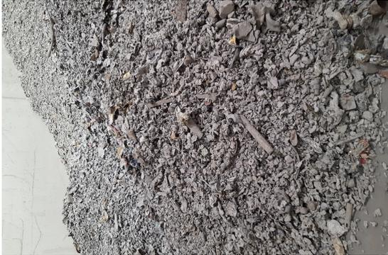
Durch Wirbelstromscheider getrennte Nichteisenmetalle aus KVA-Schlacke.
