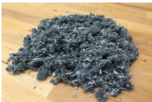
Teppich mit Schneidmühle zerkleinert (Mischung aller Komponenten)
