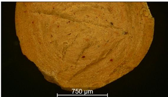
Zeolithpellet, infiltriert mittels einer wässrigen, 1M Fe(II)sulfat Lösung nach 2h Infiltrationszeit.
