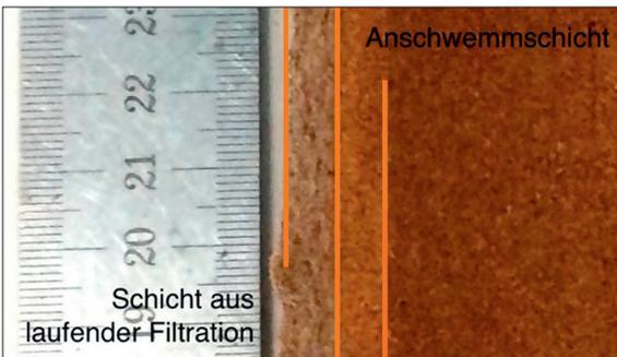
Erzeugte Filterkuchen aus Anschwemmschicht und Schicht aus laufender Filtration
