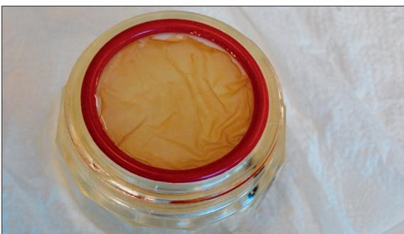
Deckschicht eines mit chloriertem Seewasser betriebenen Membranmoduls nach 32 Tagen Betrieb
