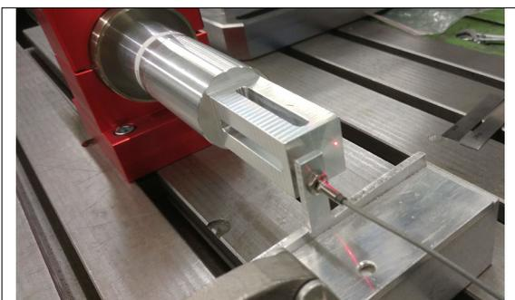
Amplitudenmessung mit Wirbelstromsensor und Laservibrometer an Sonotrode mit Langlöcher
