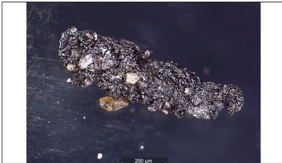
Die Reifenabriebpartikel wurden auch unter dem Mikroskop untersucht. Die Partikelgrösse lag zwischen 40µm und 500µm. Eigene Darstellung
