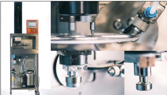
PSign Testaufbau trägt den Primer auf unterschiedlichste Kerne auf
