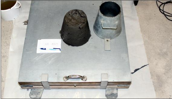
Probe für die Bestimmung des Ausbreitmasses mit Klärschlamm bei 70% TS
