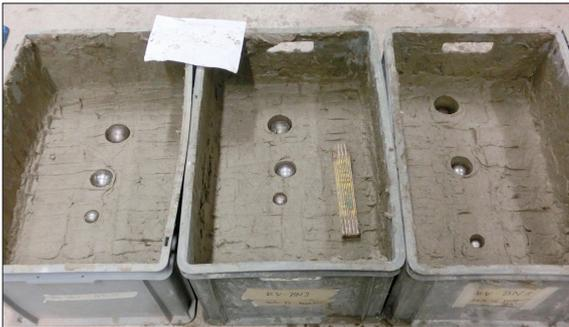
Kugelversuch mit Kieswaschschlamm unterschiedlicher Wassergehalte
