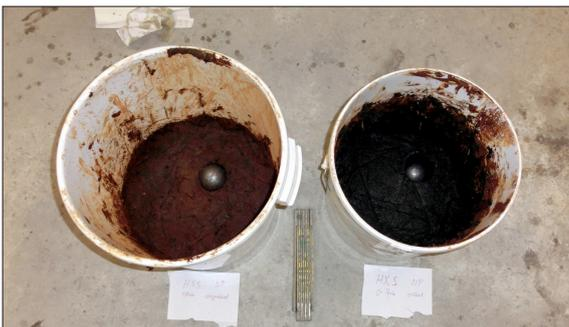
Hydroxidschlamm ungerührt und gerührt. Wegen des thixotropen Verhaltens von Hydroxidschlamm verflüssigt sich dieser durch Scherkräfte.
