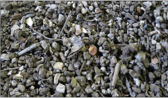
KVA-Schlacke mit metallischen Langstoffanteilen.
