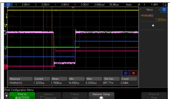
Maximale und mittlere Zeitdifferenz zwischen den Sampling-Events der Sensoren (blau, rot, grün)
