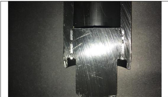
Schliffbild des Längsschnitts des realengeschweissten Inserts.
