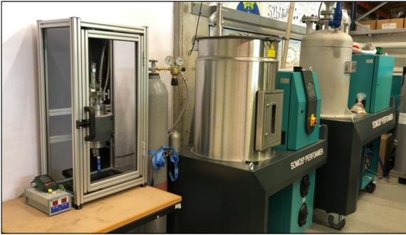
Abbildung 1: Der konzipierte Mini-Autoklav (links) und der SOMOS® Perfoamer von ProTec (rechts). Eigene Darstellung
