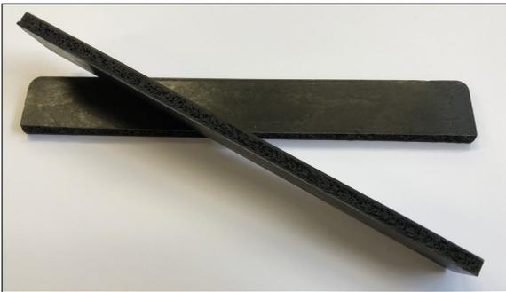
Abbildung 2: Die Schaumstruktur im Prüfkörper aus Polypropylen nach 2-stündiger CO<sub>2</sub>-Beaufschlagung des Granulats. Eigene Darstellung
