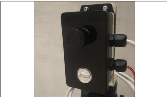
Die zu untersuchende ToF-Kamera TFM IC1 der Firma "tofmotion GmbH".
