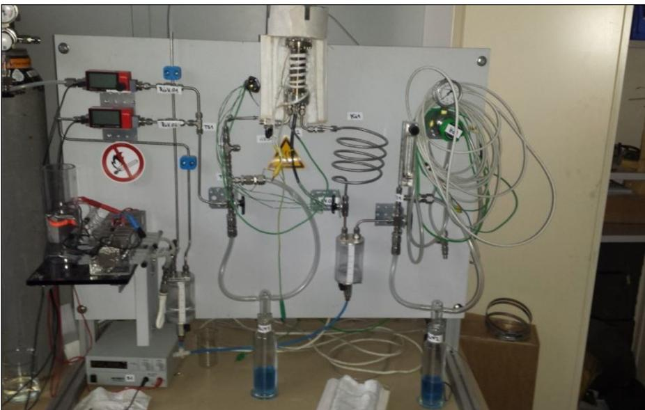
Erweiterter Power-to-Methan Versuchsstand
