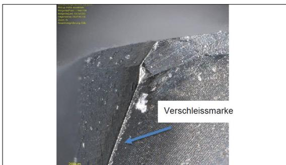
Verschleissmarke am Fräser mit Minimalmengenschmierung
