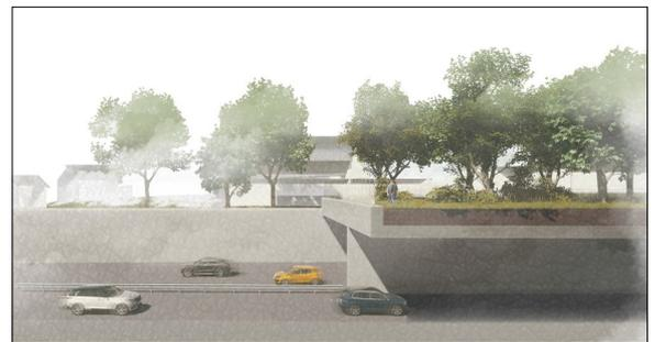
**Schnittansicht durch das Überdeckungsbauwerk, Erholungsraum über der Autobahn**
