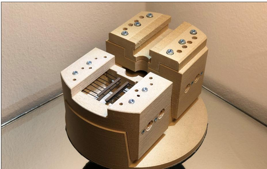
Rapidprototype des Entwurfs. Amboss mit T-Nut vorne demontiert für Sichtbarkeit der Compliantstrukturen
