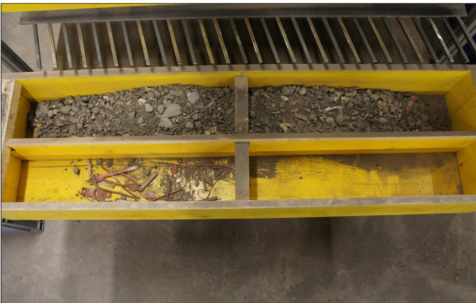
Produktboxen nach Separationsprozess: Langgut vorne, Rückstand hinten
