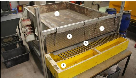
Prototyp: 1 Materialaufgabe, 2 Ablenkplatten, 3 Prallplatte mit Fingersieb, 4 Materialauffangbehälter
