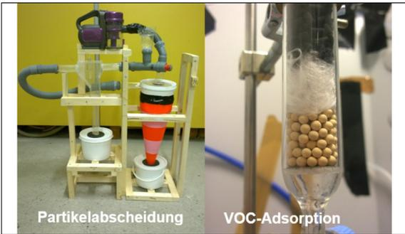
Versuchsanlage Partikelabscheidung (links), Adsorptionskolonne (rechts)
