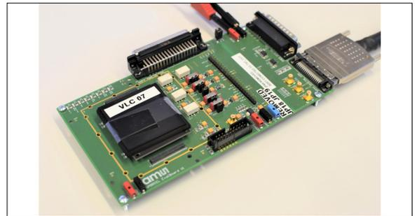
Neu entwickeltes, kompaktes und kostengünstiges System auf dem Testboard, umgesetzt mit dem FPGA. Eigene Darstellung
