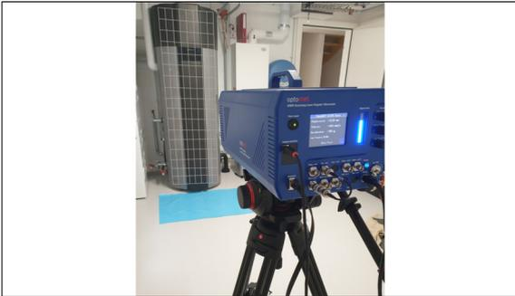
Messen eines Wärmepumpenboilers über den eingezeichneten Messbereich
