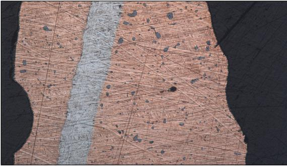
Mikroskopische Aufnahme eines Anschliffs: kupferbenetztes Feisen.
