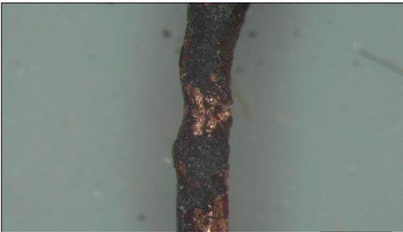
Oberflächlich oxidiertes Kupferdraht.
