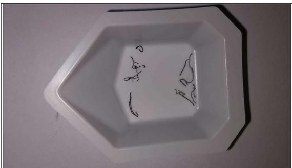
Kupferdrähte, die mittels Elektrostatikseparator aus der Schlackenfraktion 0.3-2mm gewonnen wurden.
