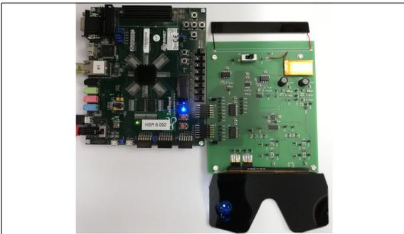
Testaufbau: Links ZedBoard und rechts Leiterplatte eingeschaltet
