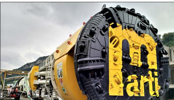
Die Abbildung zeigt die Gripper-TBM der Firma Marti. Der gesamte Nachläufer wurde in einem Eigenbau In-House gefertigt.
