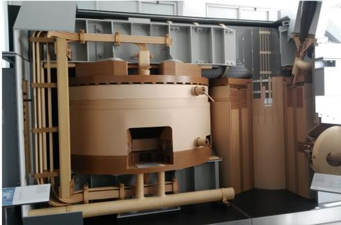
Schnittmodell eines Leistungstransformators
