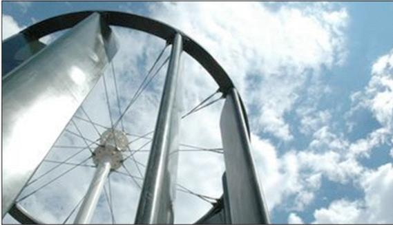
Die vertikale Windturbine von Agile Wind Power AG
