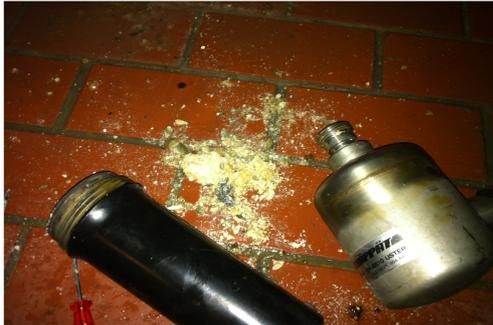
Kondensat Abscheider Biogasaufbereitung
