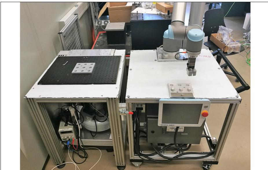
Angekoppelte mobile Roboterzelle
