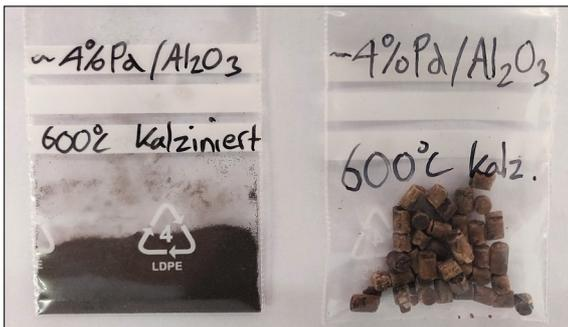
Im Rahmen der Arbeit synthetisierte Katalysatoren als Pulver und als Pellets
