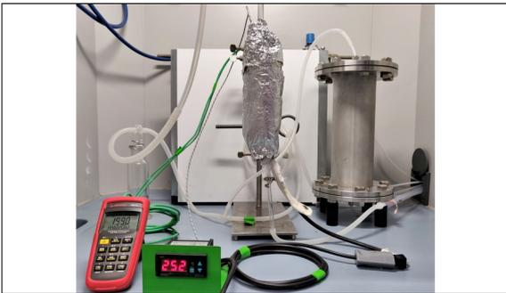
Versuchsanlage zum Testen unterschiedlicher Katalysatorpulver auf ihren Methanumsatz
