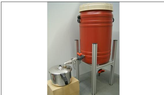
Abbildung 2: Realisierte GDM-Haushaltsanlage mit Vorlagebehälter und umfunktioniertem Kochtopf als Permeattank
