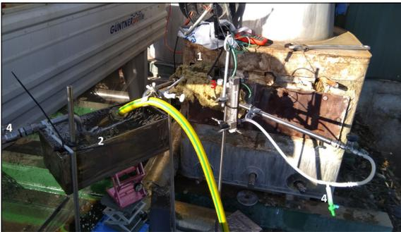
Feldaufbau: 1 Abgasentnahme, 2 Wasserkühlung, 3 Katalysator, 4 Abnahmestelle für Probenahmebeutel, Eigene Darstellung
