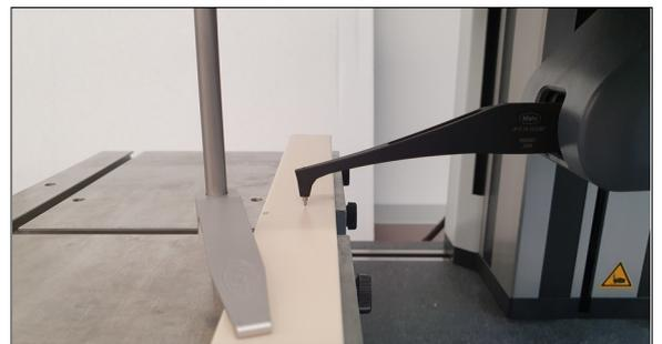
Abb.3: Einzug des extrudierten Profils in die Kalibrierung
