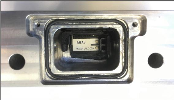
Ansicht der Spannbacke mit den eingeklebten Sensoren und der montierten Kabelhalterung
