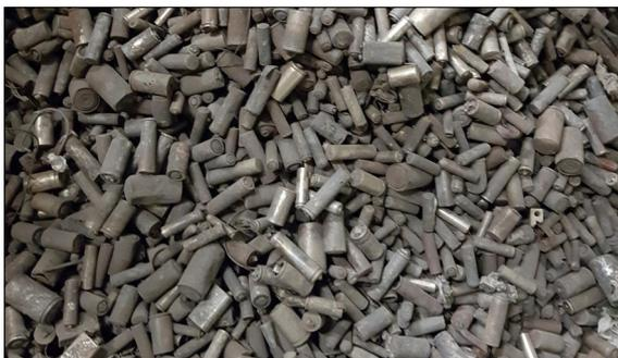
Batterien aus dem Trockenaustrag einer KVA
