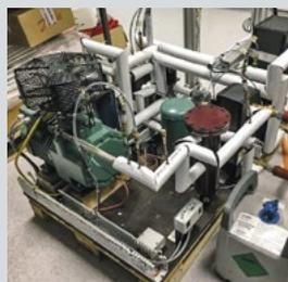
CO<sub>2</sub>-Flow-Boiling-Multi-Stage-Schabewärmetauscher zur Margarineherstellung.
