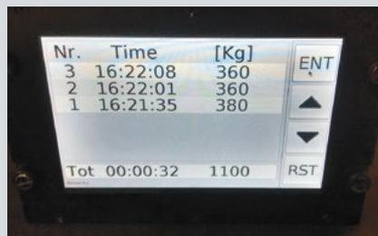
Display der Helikopterwaage.
