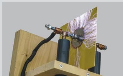
Gleitentladungen bilden Lichtenberg-Figuren auf einer Isolierplatte.
